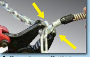
1. チェーンブライヤー(QG20093)の解放部を開き、クロスの接合部を挟み込み、端を引き上げて外します。
