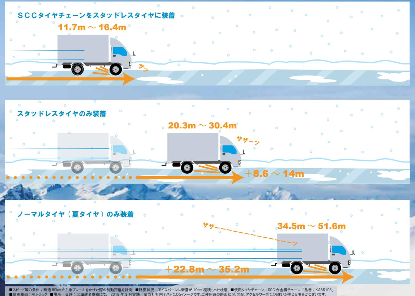
■スピード等の条件：時速50kmから急ブレーキをかけた際の制動距離を計測 ■路面状況：アイスバーンに新雪が10cm程積もった状態 ■使用タイヤチェーン：SCC合金鋼チェーン「品番：KA56103」 ■使用車両：4tトラック ■場所・日時：北海道名寄市にて、2018年3月実施 ※当社内テストによるイメージです。ご使用時の路面状況、勾配、アクセルワークにより違いが生じる場合がございます。
