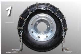
1. タイヤチェーンの裏表を確認して、カムロックがタイヤの外側になるようにタイヤの上から被せてください。クロスメンバーがタイヤトレッドに対して均等になるように調整します。
