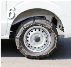
6. 車両を少し前進させ、緩みがある場合は増し締めをします。 ※耐久性も大幅に変わりますので、増締めは必ず行って下さい。
