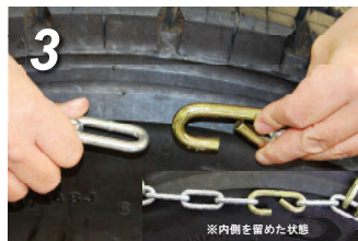
3. 内側フックを留めてください。この際、クロス全体をタイヤ内側に落とし込むと作業しやすくなります。
