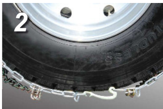
2. 外側のラッチを仮留めし、留めやすい位置まで車を移動します。留具部分を踏まないようご注意ください。
