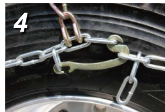
4. 内側が確実に留まっていることを確認した後、外側のラッチ部分を留めます。一本一本クロスが引っかかっていないか手で確かめながら引っ張ってください。
