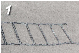
1. タイヤチェーンを広げて裏表を確認し、捻じれが無い状態にします。
