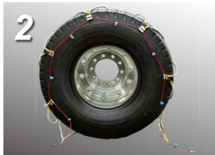
2. タイヤの外側に赤いワイヤーが来るようにタイヤの上からかぶせ、内側にずらしませ。
