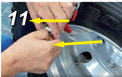
11. レバーのパネを押したまま、レバーを手前に引いてベルトをゆるめます。
