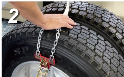
2. ラチェットがタイヤの外側、ベルト側が内側(車体側)になるようにタイヤの上から被せてください。
